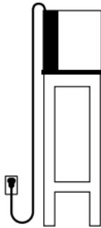
Nunca use el dispositivo con un cable de extensión a menos que el enchufe entre por completo. No intente anular esta función de seguridad.
